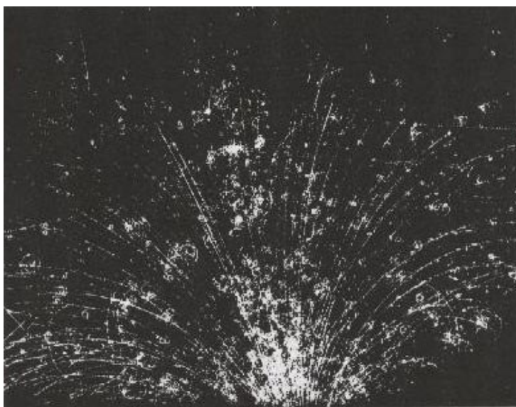
Un rayo cósmico que accidentalmente se introdujo en una cámara de burbujas provocó esta "ducha" de más de cien partículas. Los trazos horizontales corresponden a las partículas procedentes del acelerador
